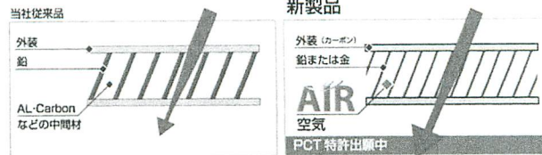
図1 エアグリッドの特長 アルミニウムを使わないために、その分透過率が向上し、低線量被ばくを実現できる
